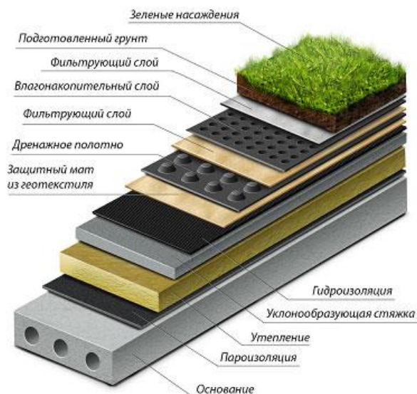
Рис. 1. Состав «зеленой» кровли
