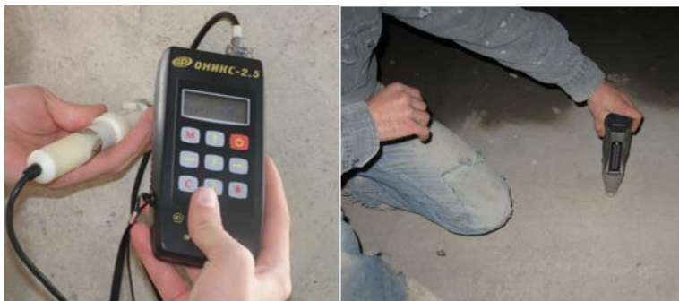
Рис. 2. Контроль прочности бетона фундаментной плиты склерометрами
